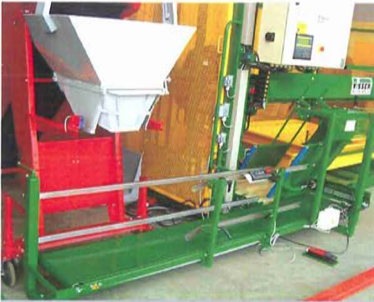
Weger gecombineerd met naaiband, afduwer en palletiseermachine De weegmachine kan ook op een aut. naaistraat aangesloten worden.
